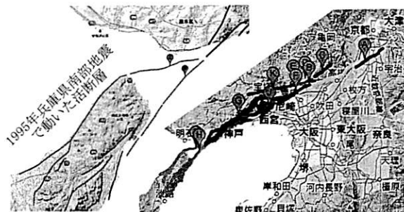
図 11.6.3 六甲淡路島断層帯から有馬高槻断層帯のセグメント区分
